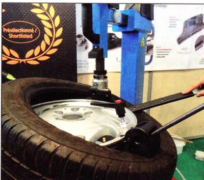
L'Espagnol Innovacion de Utiles proposait quant à lui Utilnova, un positionneur de talon qui convient à tout type de pneus (quads, voitures, 4X4, camions, véhicule industriels et agricoles) et facilite grandement le travail de l'opérateur.
