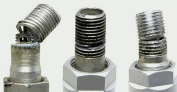
Valves de TPMS endommagées par la corrosion galvanique
